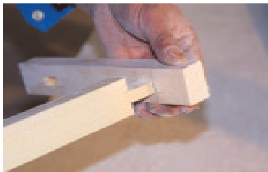
7. 在榫头上刷上乳胶，按图纸所示插接。
