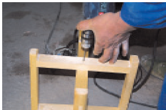
9. 用电钻在转接处钻孔并安装上长螺丝或钢筋。
