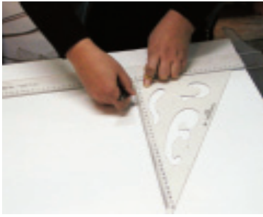
2. 根据图纸比例尺寸，用铅笔在卡板上画定门窗位置。
